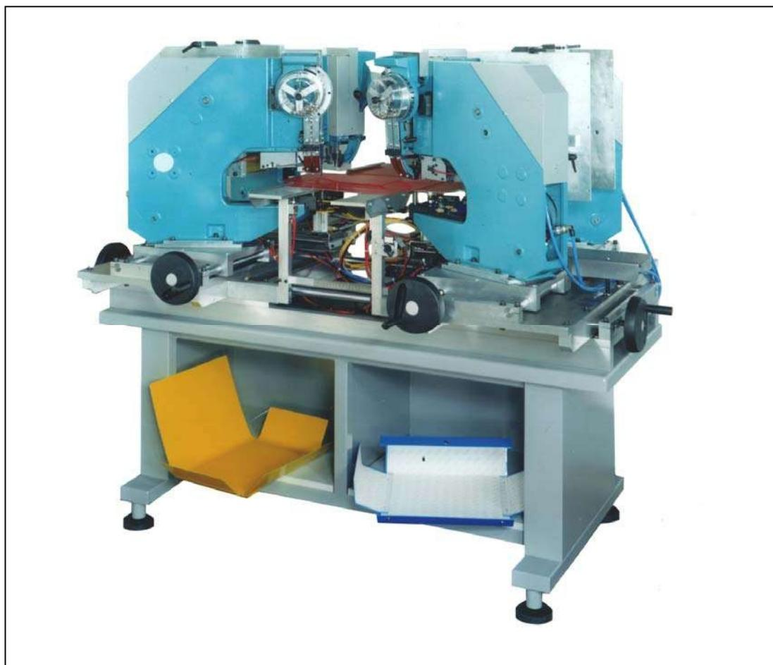
Macchina automatica per l'applicazione di alette su cartelle a bottoni o ad elastico. Composta da 4 teste occhiellatrici montate su di un dispositivo per la di variazione dell'interasse in modo semplice e veloce.
